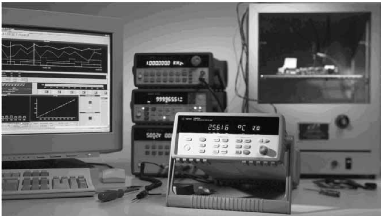
Компактная 60-канальная система сбора данных
