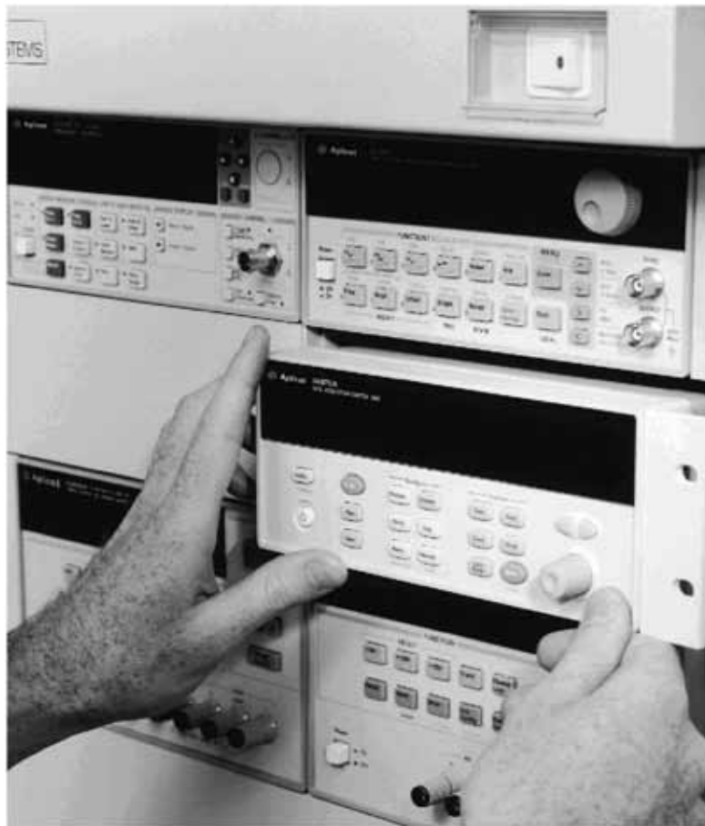
Недорогой блок коммутации для автоматизированных испытаний
